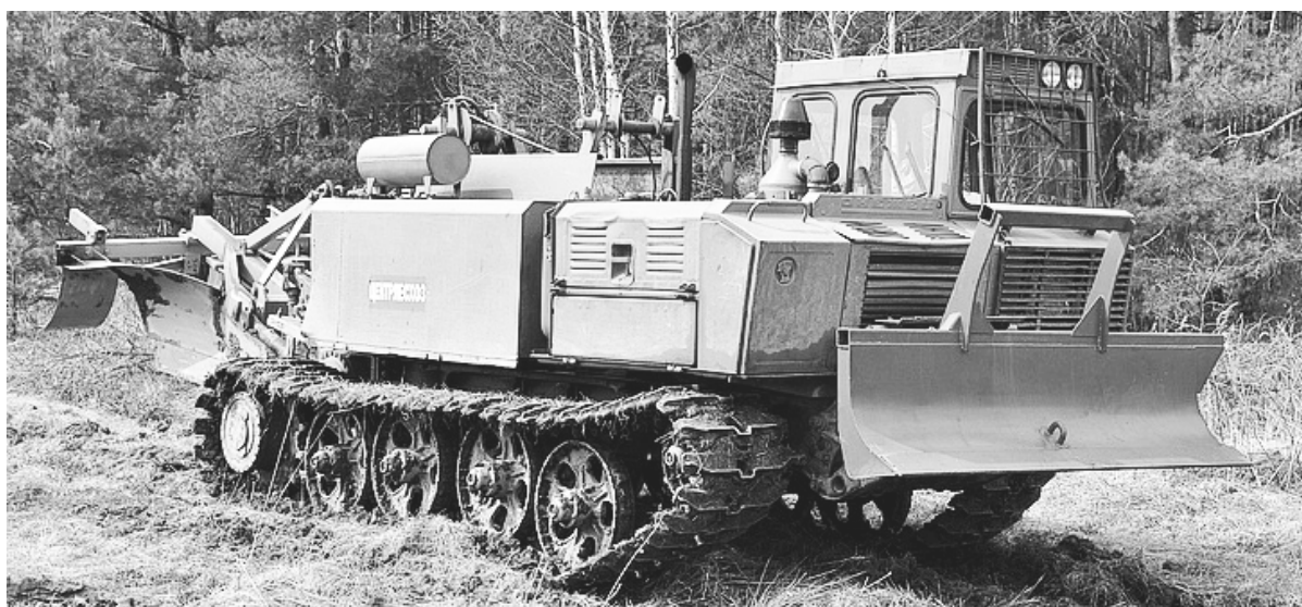
Рис. 4.8 – Лесопожарный трактор ЛХТ-100А-12 «Онежец-180-12» (вид с разных ракурсов)
